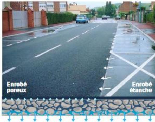
Chaussée à structure réservoir
